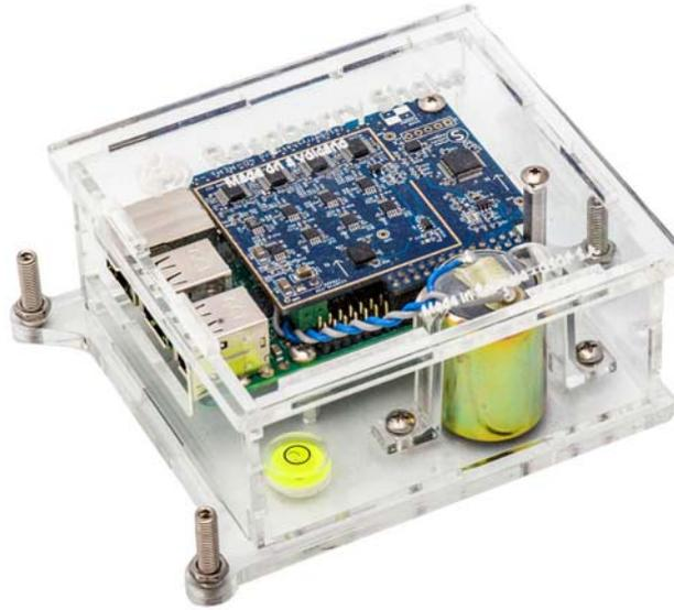
Trata-se dum modelo de 4 canais com o mesmo digitalizador do modelo anterior. Vem equipado com um geofone vertical e 3 acelerómetros MEM que registam as 3 componentes da aceleração, no caso de se terem movimentos fortes.
